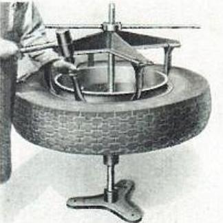
**Während des Abpressens sollen die Abstände** zwischen den 4 Klauen **mit dem Lockerungsmeißel bearbeitet werden**, wodurch der Reifen schön **gleichmäßig frei** wird.
