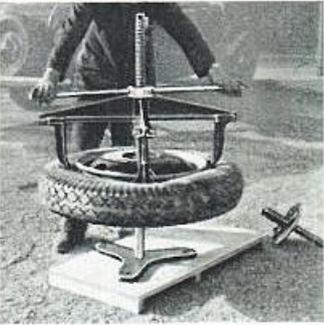
**Die Umstellung von Radhalter auf Abziehpresse geht sehr schnell vor sich.** Es wird nur die Spindel mit der Druckscheibe entfernt. Anschließend wird wie folgt am praktischsten verfahren:
