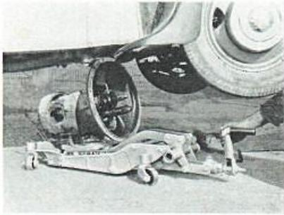
Nach erfolgter Lösung des Teiles wird die Last gesenkt. Die **tiefste Lage von 100 mm** des Teile-Hebers „GA“ gestattet: Heber und Teil **bequem** unter dem Wagen heraus und von da an die Werkbank zu fahren. Der Einbau des Teiles kann durch die **millimeterweis** zu bedienende Hubvorrichtung **peinlich genau und sehr schnell — Arbeitskräfte sparend —** erfolgen.
