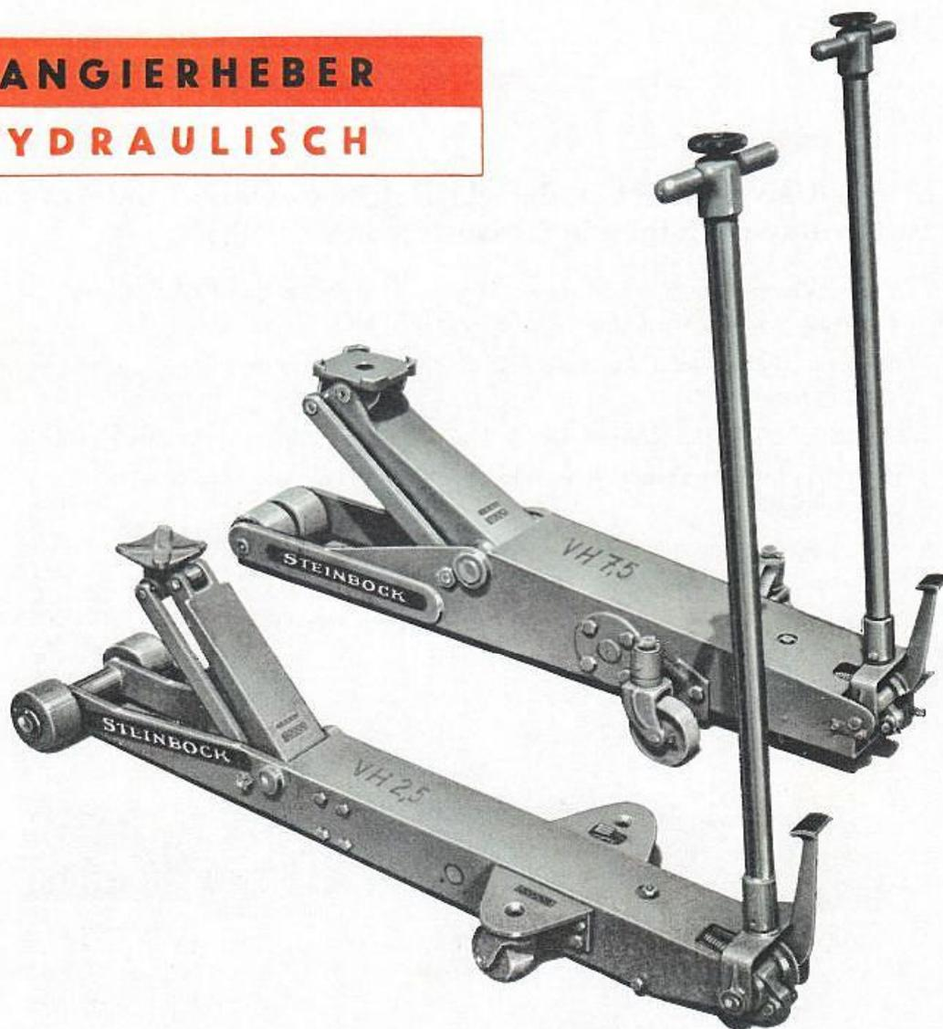
**Der hydraulische Heber erfordert weniger Handarbeit und Kraft als der mechanische Heber. Darüber hinaus arbeitet der hydraulische Heber schneller. Zum Absenken ist nur das Öffnen des Rücklaufventils erforderlich.**
