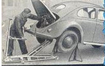
3 Motor Aus- u. Einbau durch 1 Mann
